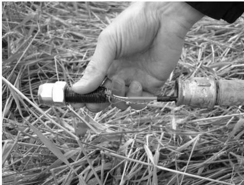
Bild 6. Messtechnische Einrichtung zur Temperaturmessung vor Ort: Datenlogger, Temperaturfühler
